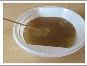
**Was passiert?** Die Pfefferteilchen zerteilen sich an der Stelle, an der die Seife ins Wasser kommt und fallen zu Boden.
